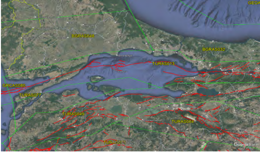
Şekil 5. Marmara bölgesinde sahaya özel olasılıksal deprem tehlikesi analizleri gerçekleştirilmek amacıyla hazırlanmış çizgisel ve alansal deprem kaynakları için bir örnek (Şekilde yeşil çizgiler alansal deprem kaynaklarını kırmızı çizgiler ise Maden Tetkik Arama tarafından 2012 yılında hazırlanmış çizgisel deprem kaynaklarını göstermektedir.)
